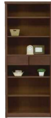
商品コード 1842 75フリーボード BR色 W750×D340×H1835 棚板 / W676×D291×H20 引出内寸 / W600×D262×H91 可動棚板 / 4枚 棚タボ60mm間隔 上部9段・下部9段 引出 / 2杯 ¥49,400 [税別] 才数 17.4 / 個口数 1 約28kg
